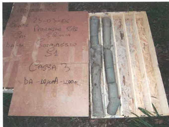
Sondaggio S1 Cassa 3 da -10,00 a -12,00 m dal p.c.
