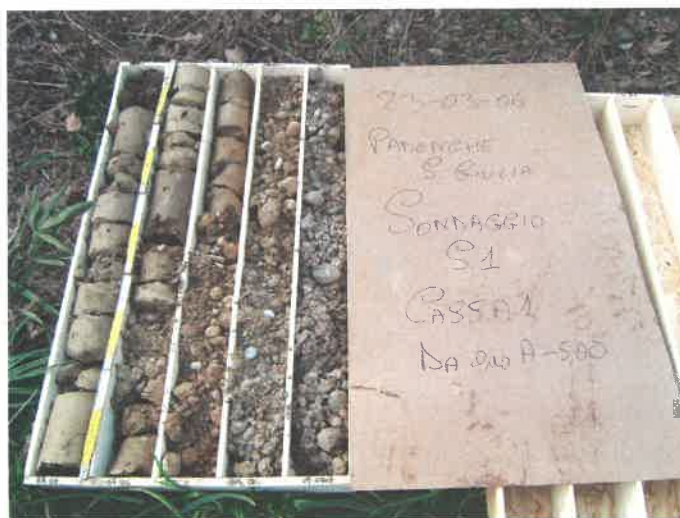
Sondaggio S1 Cassa 1 da 0,00 a -5,00 m dal p.c.
