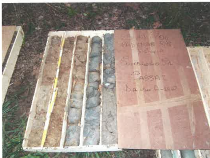
Sondaggio S1 Cassa 2 da -5,00 a -10,00 m dal p.c.
