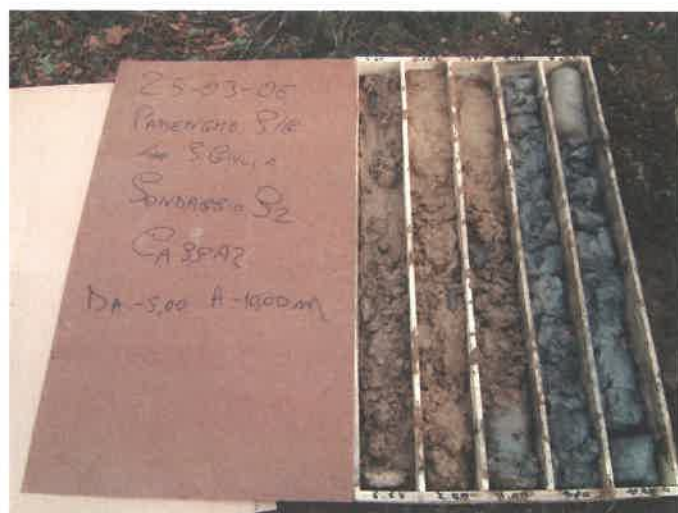
Sondaggio S2 Cassa 2 da -5,00 a -10,00 m dal p.c.
